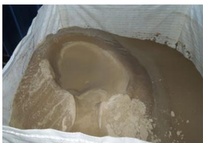
Egouttage puis séchage de la struvite produite dans un sac filtrant lors des essais sur la STEP de Braunschweig (Allemagne) avec des rendements d'élimination du phosphore supérieurs à 85%
