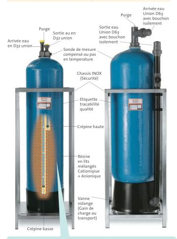
Dans un lit mélangé; les H' et OH $^-$  préalablement fixés sur les matrices des résines cationique et anionique lors des phases de régénération, s'échangent avec les cations (+) et anions(-) présents dans l'eau. Les résines sont ensuite presque entièrement saturées et doivent être régénérées. Ces ions H+ et OH $^-$  libérés se recombinent instantanément pour créer de nouvelles molécules d'eau : H' $^+$  + OH $^ ^-$  HOH $^-$  H2O
