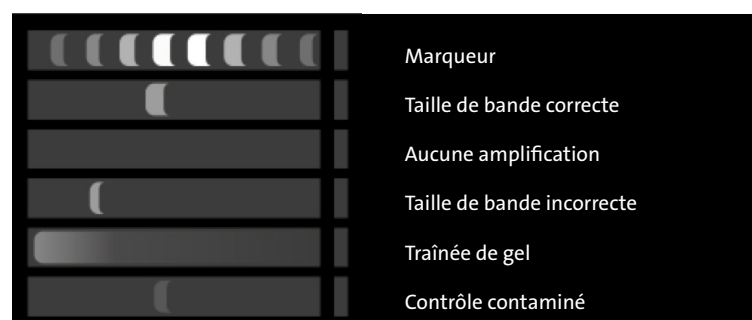
Figure 12 : illustration d'un gel d'agarose montrant différents types d'erreur qui se produisent en cas d'utilisation d'une eau de mauvaise qualité pour la PCR.
